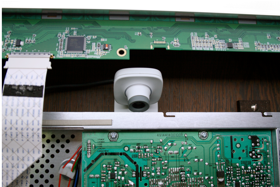
Figur 4.11: Kameran är monterad ovan plattskärmens kretskort
