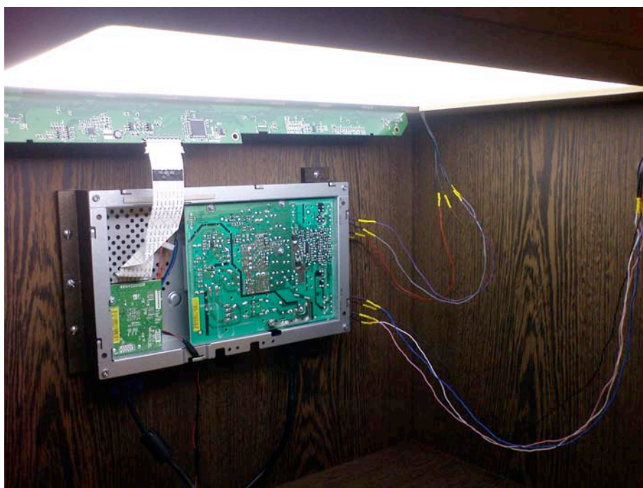
Figur 4.9: Plattskärm monterad i chassi
