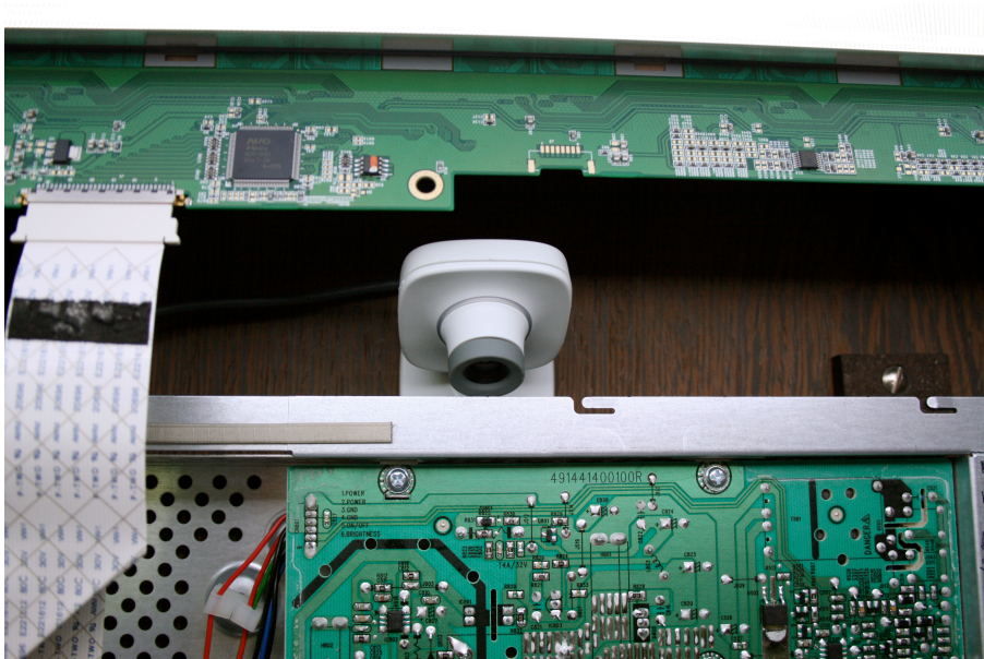
Figur 4.12: Kameran är monterad ovan plattskärmens kretskort
