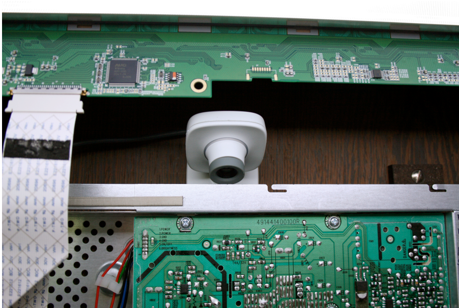
Figur 4.12: Kameran är monterad ovan plattskärmens kretskort
