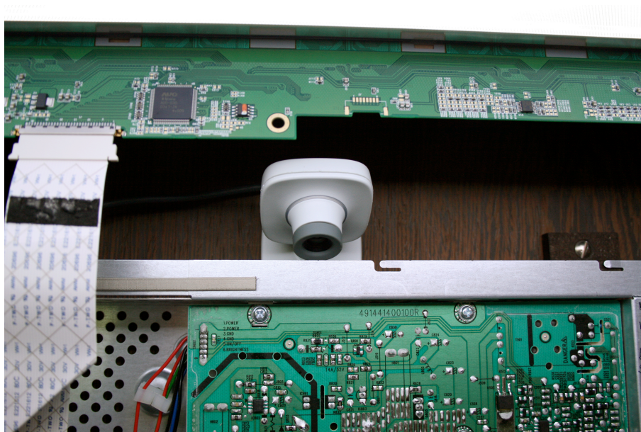
Figur 4.11: Kameran är monterad ovan plattskärmens kretskort
