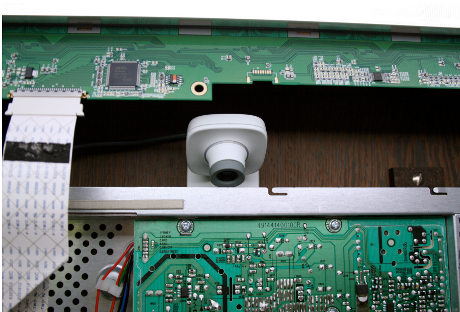
Figur 4.11: Kameran är monterad ovan plattskärmens kretskort
