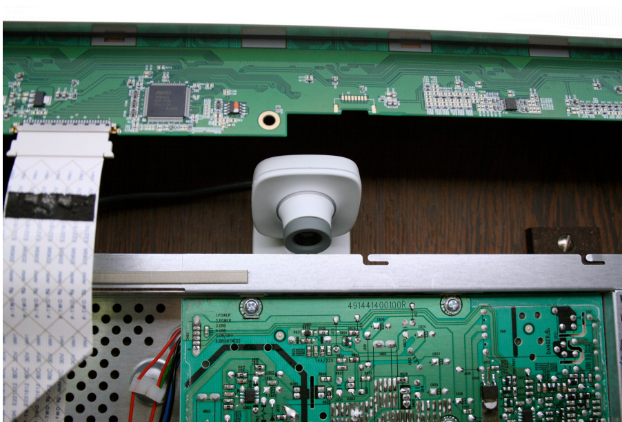
Figur 4.11: Kameran är monterad ovan plattskärmens kretskort
